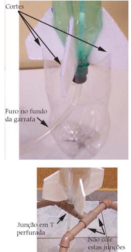
Figura 5. Opções para a construção da base de lançamentos. Em (a), base construída com uma garrafa PET. Em (b), base construída com tubos e conexões de PVC.
